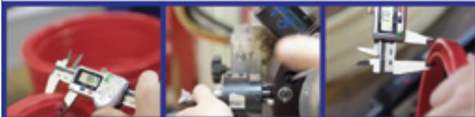
Durch unsere langjährige Erfahrung in Hydraulik- Zylinderreparaturen und mit Hilfe einer CNC-Drehmaschine, sind wir nun in der Lage, eine Vielzahl an Dichtungen kurzfristig nach Maß zu fertigen.
